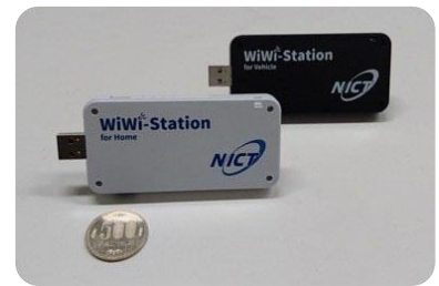
今回開発した宅内/車載用のすれ違い IoT 無線ルータ
