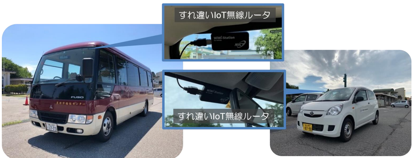
図 2 すれ違い IoT 無線ルータを搭載した黒部市社会福祉協議会保有のバス及び業務用車両の様子
