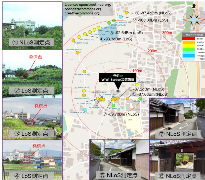
図6 木造家屋にすれ違いIoT無線ルータを設置した場合の通信可能エリア検証結果一例
