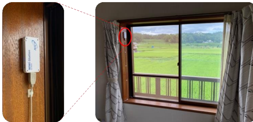
図5 すれ違いIoT無線ルータを木造家屋2階の窓際に設置した様子
