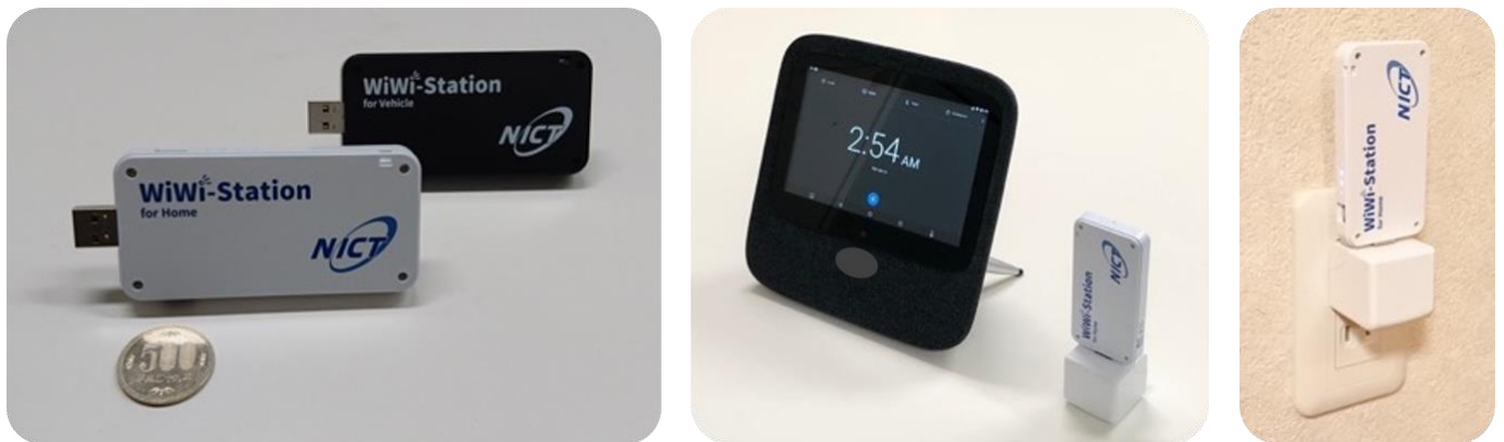
図 1 (左)開発した宅内用及び車載用のすれ違い IoT 無線ルータの外観 (中央)実証実験用タブレットに同ルータを組み合わせて配置した場合の外観 (右)宅内コンセントに同ルータを設置した様子
